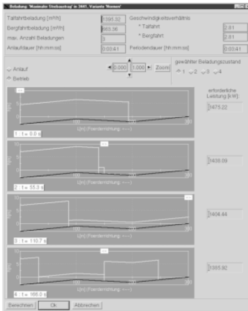
Bild 3. Gewinnungsrechnung, Visualisierung verschiedener Belastungszustände in einem Hobelstreb.
