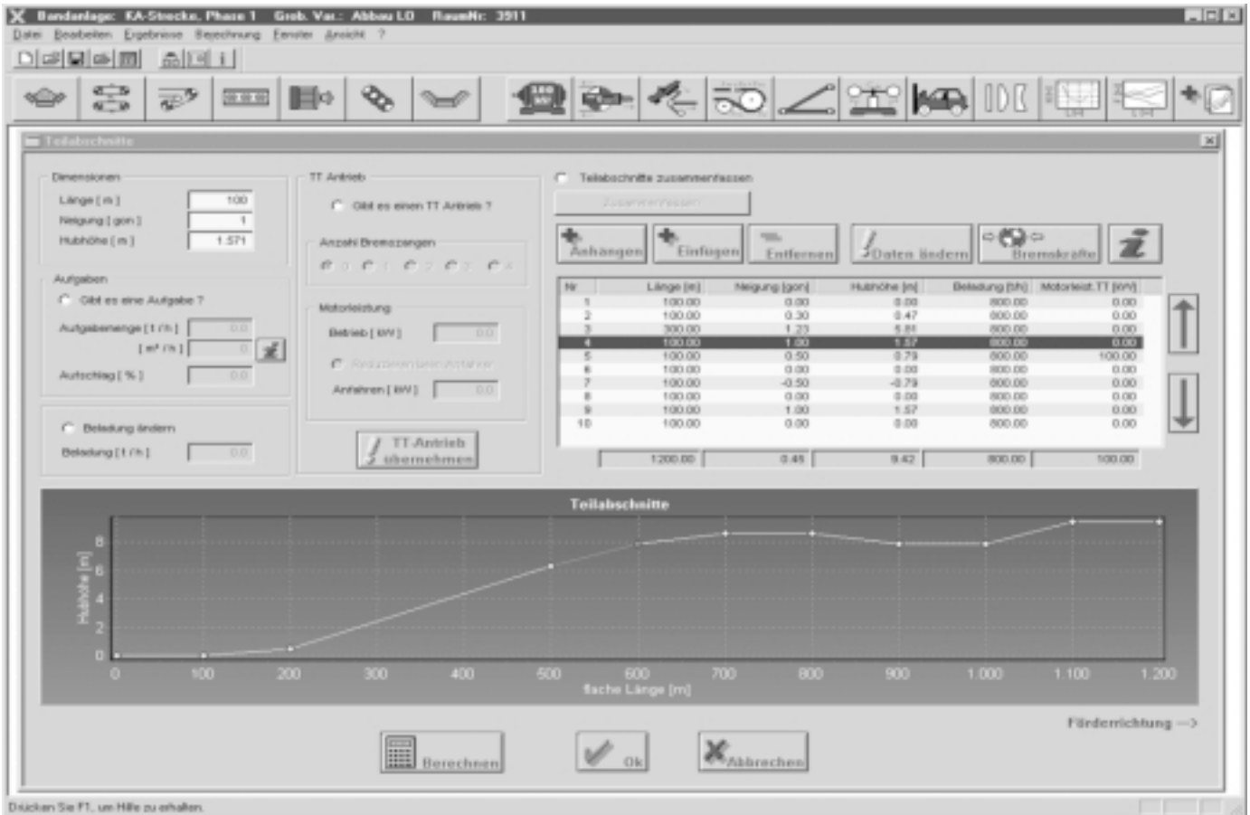
Bild 2. Gurtfördererberechnung, Definition der Förderergeometrie.
