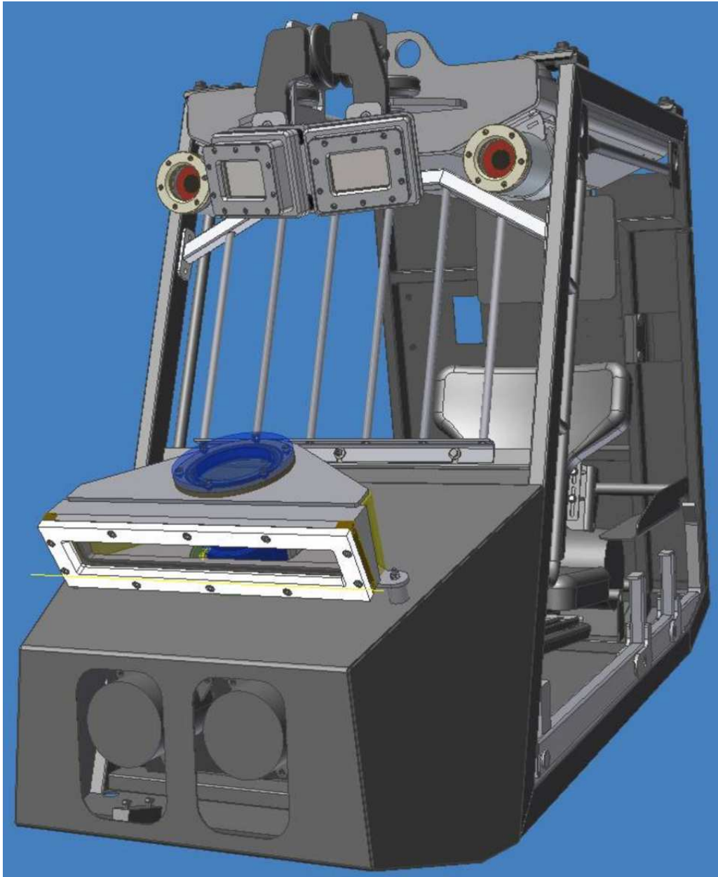
Abb. 5a – Fahrerkabine mit Sensoren und Infrarot-Videokameras
