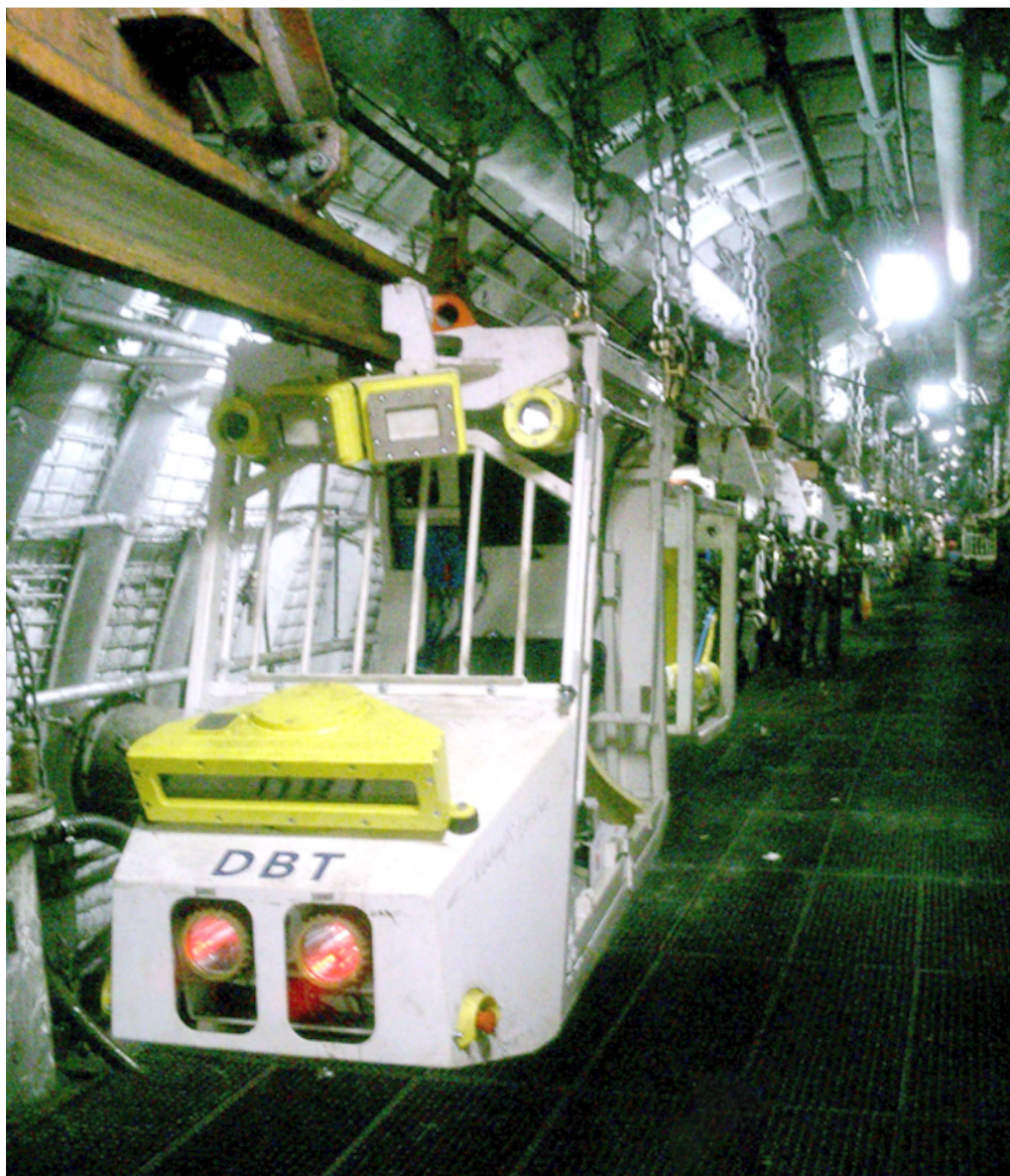
Abb. 5b – Fahrerkabine mit Sensoren und Infrarot-Videokameras
